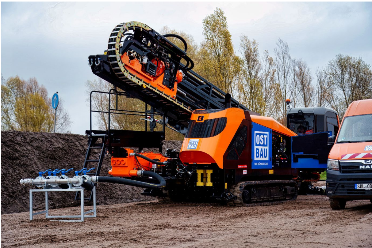
Foto ©OST BAU (2024): HDD-Technik im Einsatz auf der Baustelle in Einbeck, Niedersachsen
